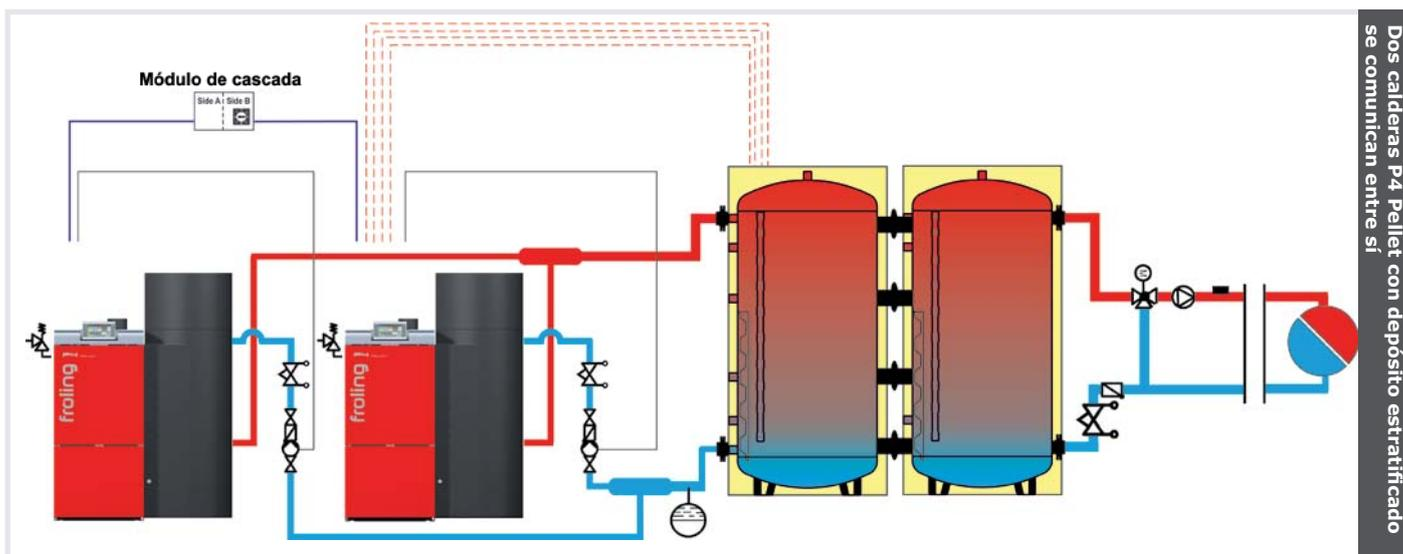
Dos calderas P4 Pellet con depósito estratificado se comunican entre sí
