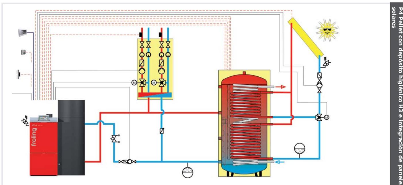
P4 Pellet con depósito higiénico H3 e integración de paneles solares
