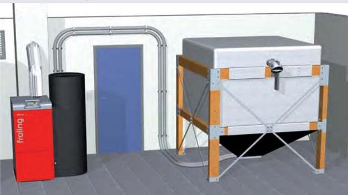
Los sistemas de silo textil son una opción flexible y sencilla para almacenar pellets. Existen 9 superficies diferentes disponibles (de 1,5 m x 1,25 m hasta 2,9 m x 2,9 m) con una capacidad de 1,6 a 7,4 toneladas, dependiendo de la densidad aparente.
