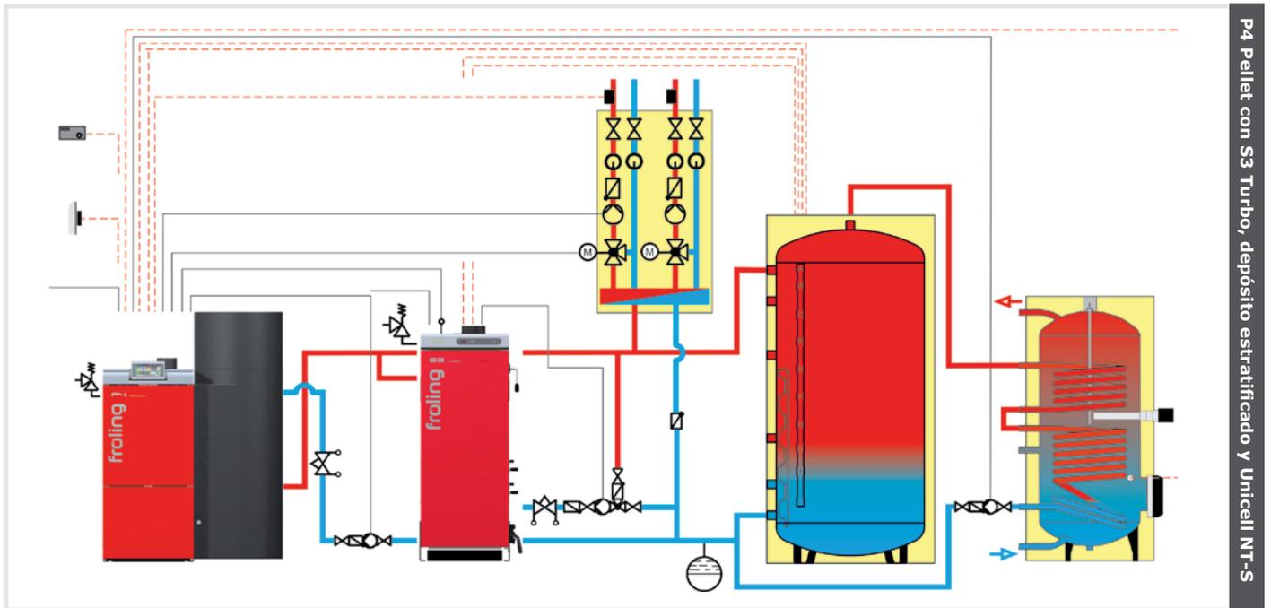
P4 Pellet con S3 Turbo, depósito estratificado y Unicell NT-S
