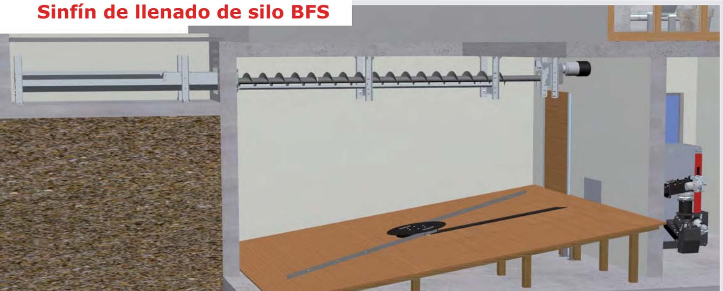
Mediante la rampa de descarga situada fuera del silo, el sinfín de llenado de silo introduce el combustible en el silo. El sinfín de llenado de silo se detiene automáticamente cuando el silo está lleno. El suelo inclinado del silo representado en la imagen no es necesario para el perfecto funcionamiento de la extracción.
