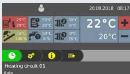
Fig. 1: Vista de conjunto del circuito de calefacción (pantalla de inicio)
